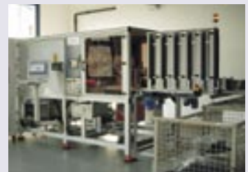
Erfolgreich getüftelt: Kameraprüfung nach Displaymontage bzw. vor dem Beschriften, automatisches Lasern und Verpacken mit „Speedy“ (v. oben) · Successfully constructed: Camera check after display assembly, before etching, automatic lasing and packing with “Speedy” (from top)
