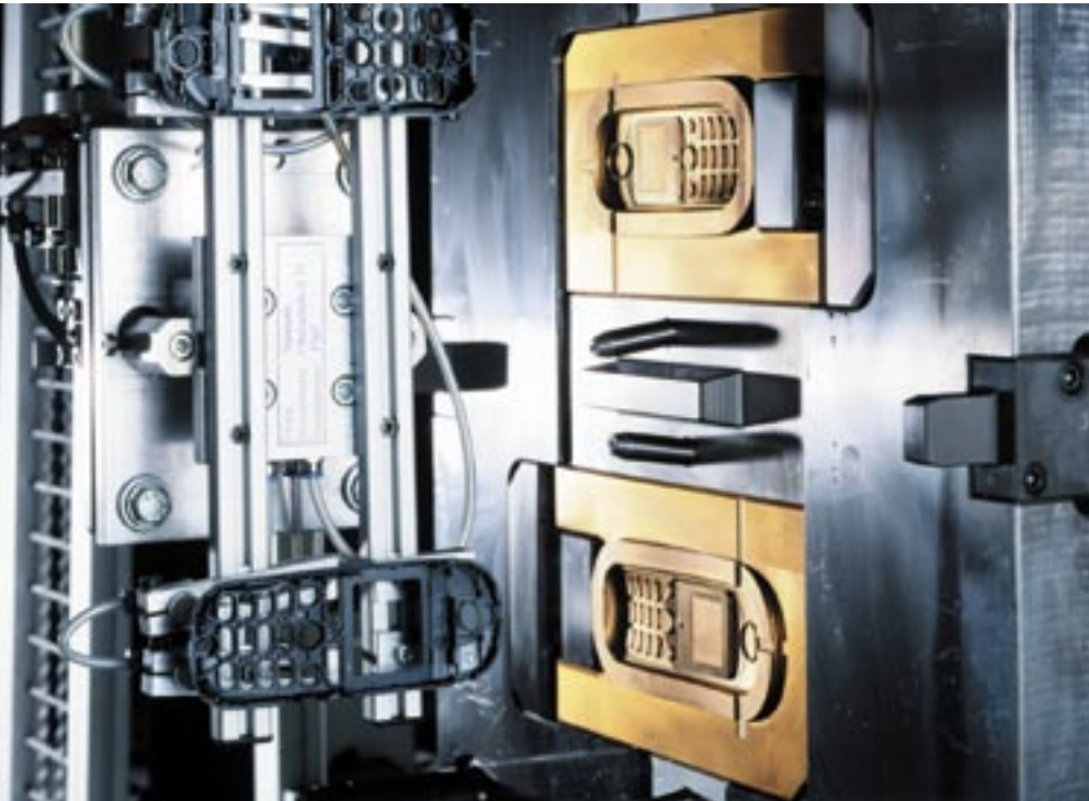
Kli -Spritzgießwerkzeug mit TIN-Beschichtung für hohe Ausbringung · TIN coating for optimal wear performance
