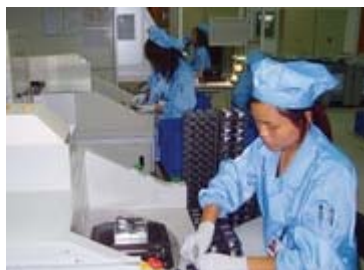
Mitarbeiterinnen im Unikun-Werk Suzhou/China beim Laseretching spritzgegossener Automotive-Tasten
