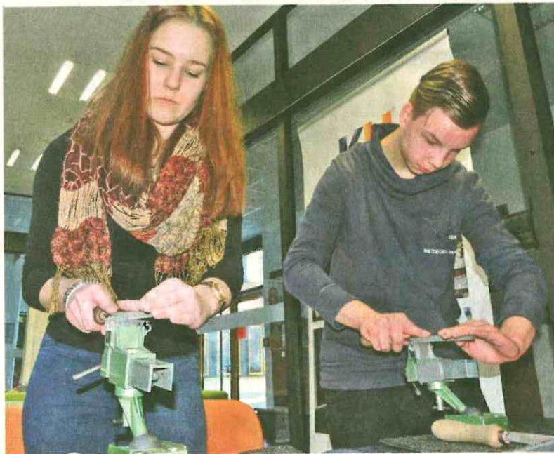
Jenny und Jan beim Feilen eines Schlüsselanhängers. „Der Anhänger ist CNC gefräst, die Kerbungen sind schon vorhanden“, erklärt dazu Azubi Dennis Spörl. „Jetzt gilt es, sie mit der Dreikantfeile weiter zu bearbeiten.“ Foto: Sandra Hüttner
