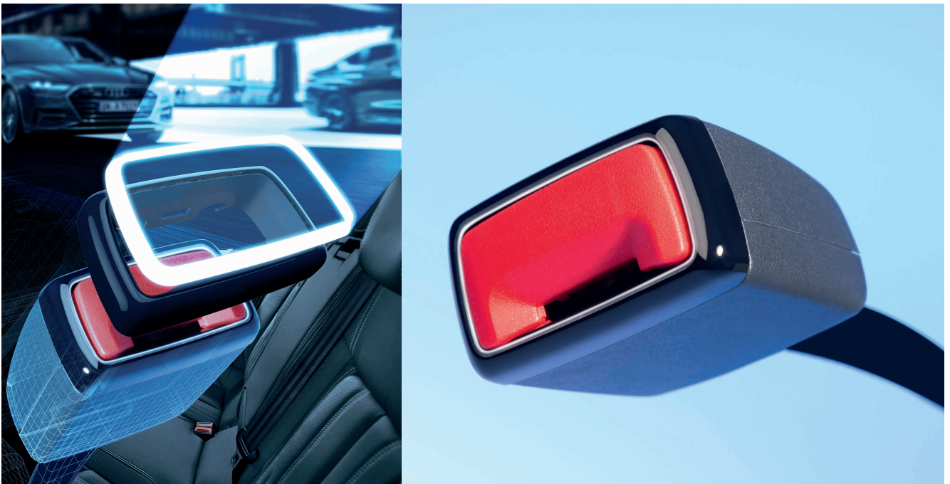
Nie mehr nach dem Gurtschloss tasten: Ein integrierter Lichtleiter gibt den Fahrzeuginsassen im Dunkeln Orientierung. Doch der Fertigungsprozess hat es in sich (© KH)
