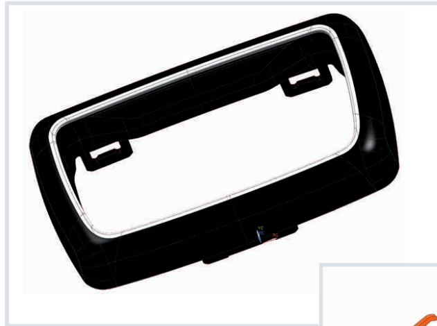
Bild 1. Innenkontur und äußere Abdeckung des Lichtleiters (in der Realität beide schwarz, in der Grafik zur besseren Unterscheidung grün und orange) lassen sich nicht in einem Vorgang formen (© KH)
