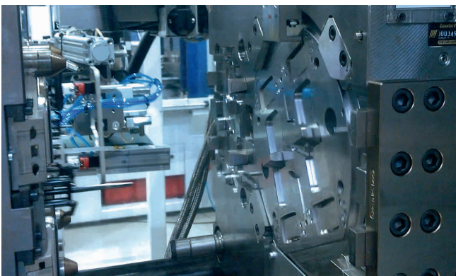
Bild 4. Der Drehteller dreht sich um 180°, sodass der frisch gespritzte Lichtleiter aus PC auf der Auswerferseite in Station 2 gelangt (Standbilder aus einem Video). Dort entsteht aus schwarzem PC+ABS die Innenkontur mit Montageelementen (© KH)
