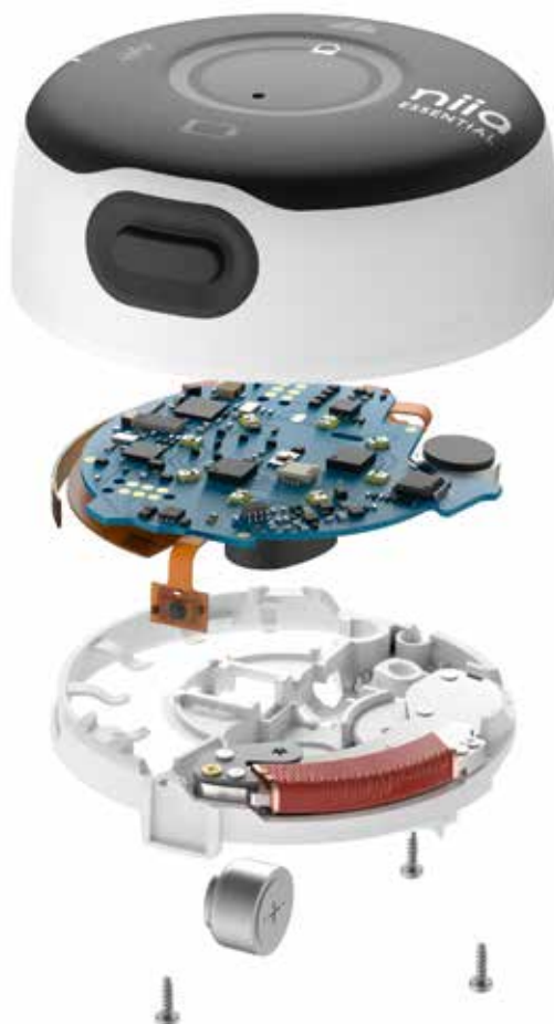
Kunststoff Helmbrechts verbaut insgesamt zwölf Komponenten im Gehäuse der Insulin-Patch-Pumpe.
