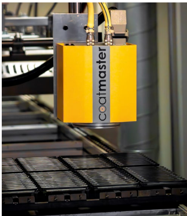
Die Schichtdicke auf den Kunststoffbauteilen wird direkt nach dem Lackauftrag automatisiert gemessen. Foto: coatmaster
