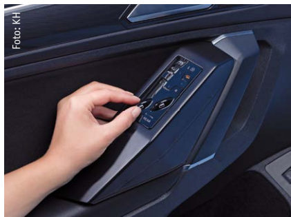
Potenzial für die Zukunft: Das zur K 2019 vorgestellte und im IML realisierte Smart Door Panel beinhaltet neben dem kreuzförmig vertieften Finger-Guide auch eine kapazitive zwei-Finger-Sicherheitsbedien-ung für die Fensterscheibe.
