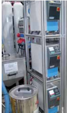
Die Temperiergeräte sind übereinander angebracht (links), die Materialtrocknung erfolgt direkt an der Maschine. The temperature control units are placed one above the other (left), drying of the material takes place directly at the machine
