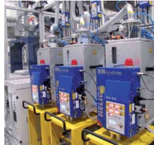
Die Temperiergeräte sind übereinander angebracht (links), die Materialtrocknung erfolgt direkt an der Maschine. The temperature control units are placed one above the other (left), drying of the material takes place directly at the machine
