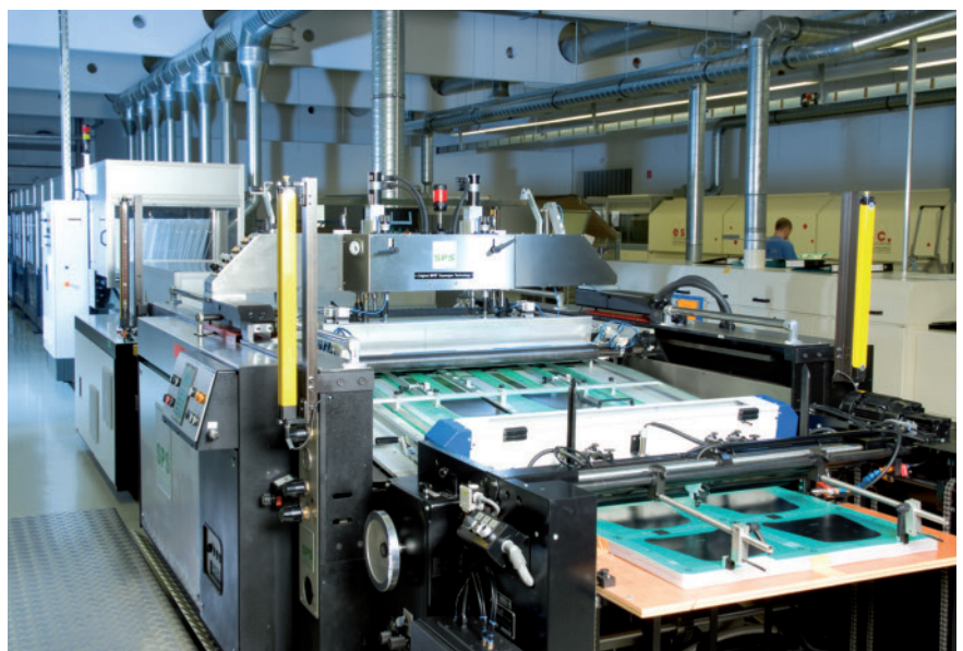
Eine vollautomatische Zylinderdruckmaschine bringt in fünf Stufen Farbe und Bedienfelder auf die Folien auf
