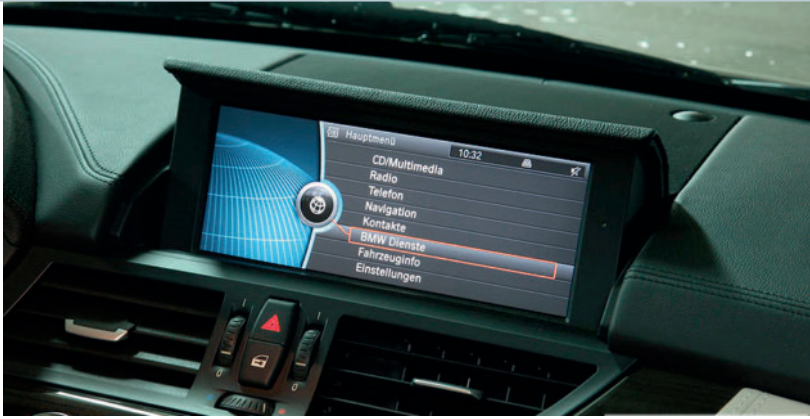
Klappmonitore sind ein ideales Einsatzgebiet für die neue Technik. Der im Vergleich zu Stahlseilen geringere Umlenkradius von Kunststoffseilen eröffnet eine größere Designfreiheit (Fotos: auto motor und sport, N24)
