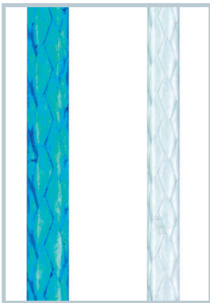
Blaues und weißes Seil: Die Basis für Wirelution ist ein hochfestes, stark verstrecktes Seil mit extrem geringer Dehnung aus einem PE-HMW (Bild: Kunststoff Helmbrechts)
