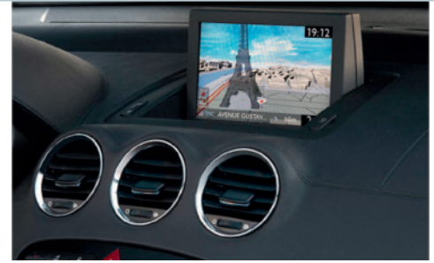
Klappmonitore sind ein ideales Einsatzgebiet für die neue Technik. Der im Vergleich zu Stahlseilen geringere Umlenkradius von Kunststoffseilen eröffnet eine größere Designfreiheit (Fotos: auto motor und sport, N24)
