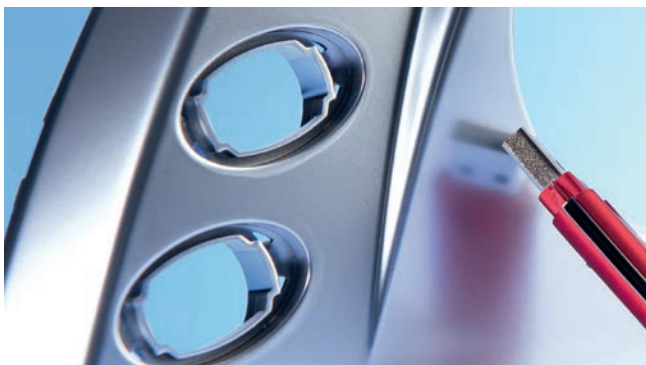
Bild 3. Der Spiegeleffekt tritt nur ein, wenn der Chromlack maximal 1 bis 3 µm dünn aufgetragen wird (© Kunststoff Helmbrechts)
