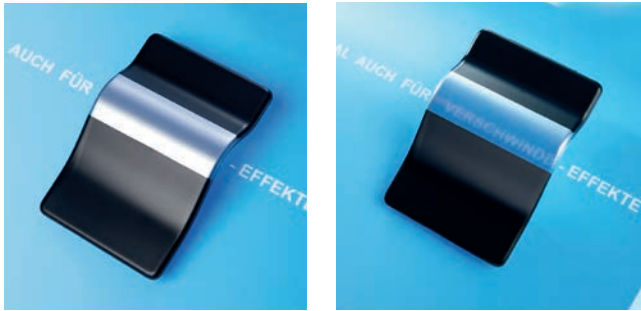
Bild 4. Ohne schwarze Grundierung der Chromlackierung lassen sich Verschwindeffekte erzielen (© Kunststoff Helmbrechts)
